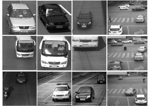
图 7 利用卷积神经网络进行车牌定位效果
