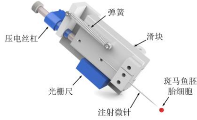
图 3 细胞穿刺机构的结构图
