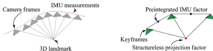
图7 视觉惯性里程计的观测组织与因子图建模示意图 [54]
