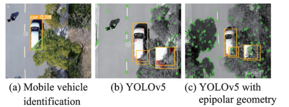
图 5 仅使用 YOLOv5 方法与结合对极几何方法剔除动态点的效果对比
