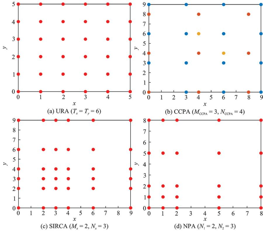
图8 4种面阵的结构示例
