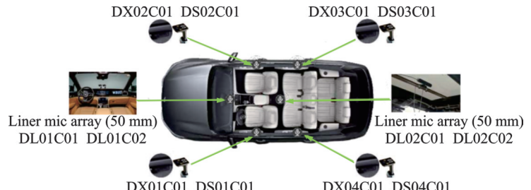
图 10 基于分布式麦克风阵列的 ICMC-ASR 系统
