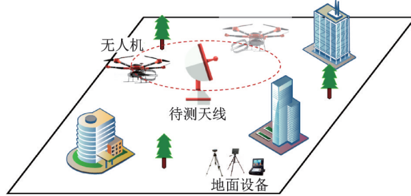
图1 无人机室外天线三维方向图测量
