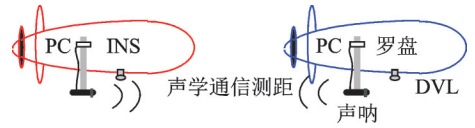
图4 水下声学通信示意图
