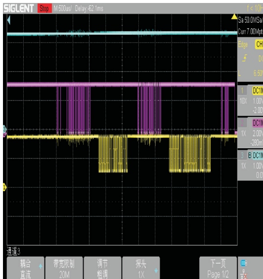
图11 子节点接收无线指令并响应时序波形
