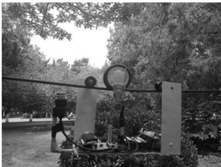
图8 巡检机器人与实验测试现场图
