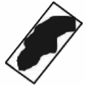
图 3 单个区域的最小外接矩形 Fig. 3 Minimum bounding rectangle of a single region
