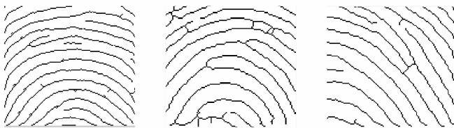
(c) 改进的软K段主曲线算法提取指纹骨架图
